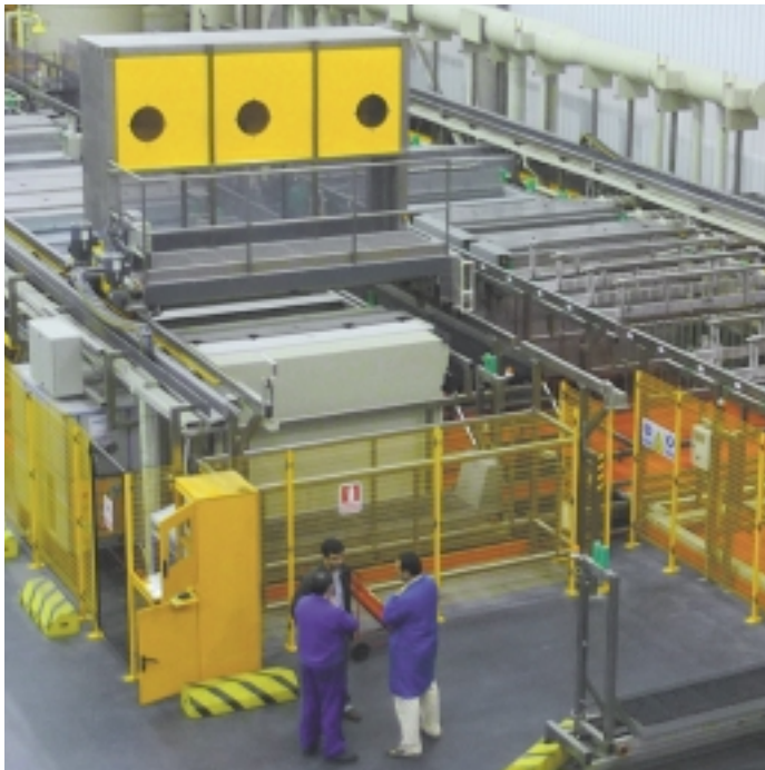
AHC Volautomatische installatie voor een loodvrij chemisch nikkelproces (Durni-Coat®)
